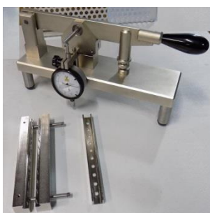
Comparatore (10036005) per la misura dell' intaglio.
