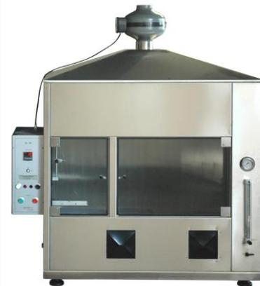
Cabina di prova utilizzata in vari settori industriali per eseguire i seguenti test di infiammabilità:
